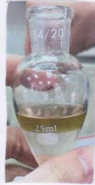
⑤ 收集有機層, 之後可以再以 10 ml 的飽和食鹽水沖洗 → 萃取。完成後將有機層倒入燒杯中, 以無水硫酸鎂去水。
