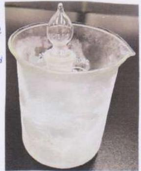
② 在一個 50 ml 的乾淨燒杯中加入 0.3 g maleic anhydride 和 2 ml E.A. (乙酸乙酯), 蓋上錶玻璃, 搖晃燒杯使 maleic anhydride 溶解。
