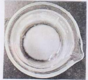
⑤ 再結晶, 重新蓋上錶玻璃, 並加熱(小火)搖晃, 直到完全溶解, 隨後置於桌面, 移除錶玻璃, 搨風, 等待結晶。
